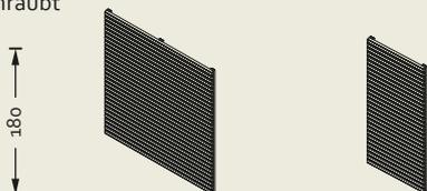
Einzelne Rhombusleisten 23/56 mm, keilgezinkt Lagerlänge 6 m
